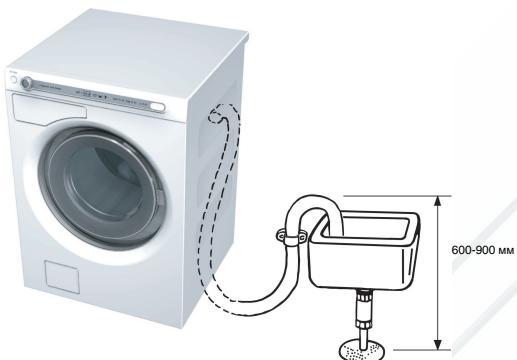
Машина также может быть подключена к стоку с помощью втулочного соединения. В таком случае шланг также должен находиться на высоте 600-900 мм над уровнем пола. Внутренний диаметр отверстия должен составлять не менее 18 мм.
