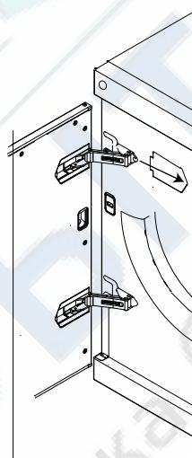
5. Снимите защитные прокладки с петель, подталкивая их в боковом направлении. Само направление - вправо или влево - будет зависеть от того, каким образом дверца закреплена на машине.
